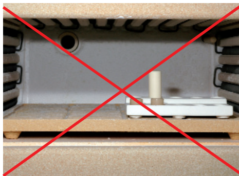
Не прогревайте заготовки IPS e.max Press и алюмоксидный плунжер
