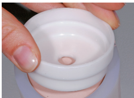
Заполните кольцо паковочной массой до маркировки и установите ограничитель вращательным движением.
