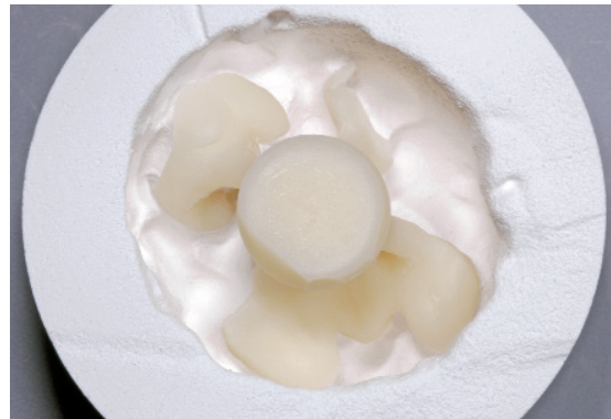
Черновая распаковка осуществляется стеклянной полировочной дробью под давлением 4 атм. (60 psi).
