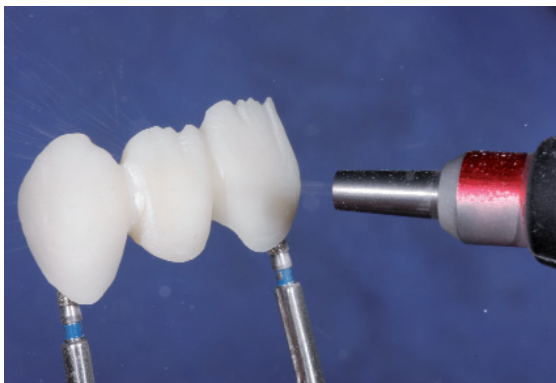
Отпескоструйте реставрацию частицами \text{Al}_2\text{O}_3 (Тип 100) (тип 100) под давлением 1 атм (15 psi). Перед смачивающим обжигом тщательно очистите реставрацию паром и высушите.
