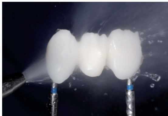
Отпескоструйте реставрацию частицами \text{Al}_2\text{O}_3 (Тип 100) (тип 100) под давлением 1 атм (15 psi). Перед смачивающим обжигом тщательно очистите реставрацию паром и высушите.
