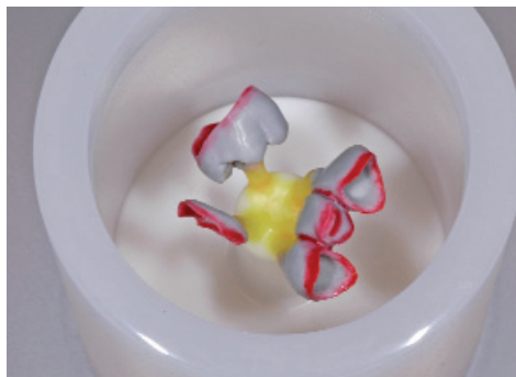
Используйте силиконовое кольцо IPS Silicone Ring для паковки. Заполняйте опоку паковочной массой медленно и тщательно.
