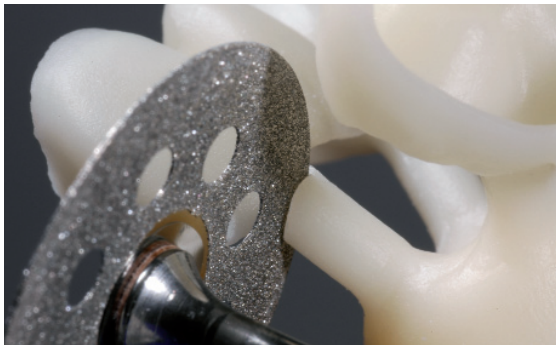
Отрежьте литники с помощью мелкозернистого алмазного диска
