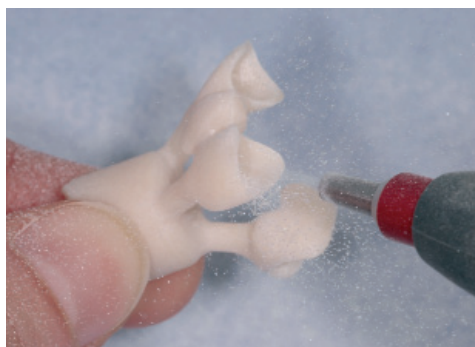
Полностью удалите реакционный слой частицами Al 2 O 3 под давлением 1-2 атм (15-30 psi).
