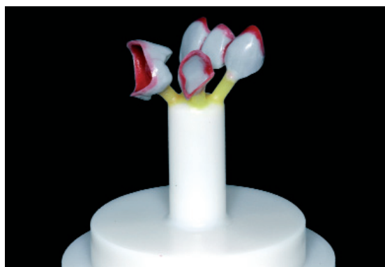
Установка литников проводится на цоколь муфельной системы IPS e.max. Литники присоединяются в направлении потока керамики и всегда к самой массивной части реставрации.
