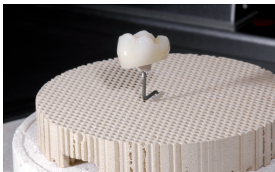
СПроведите глазуровочный обжиг на сотовом лотке с указанными параметрами
