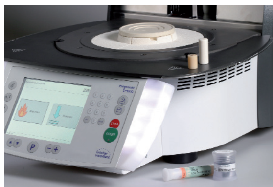
Подготовьте холодный изолированный IPS e.max Alox плунжер и холодную заготовку IPS e.max Press желаемого цвета.
